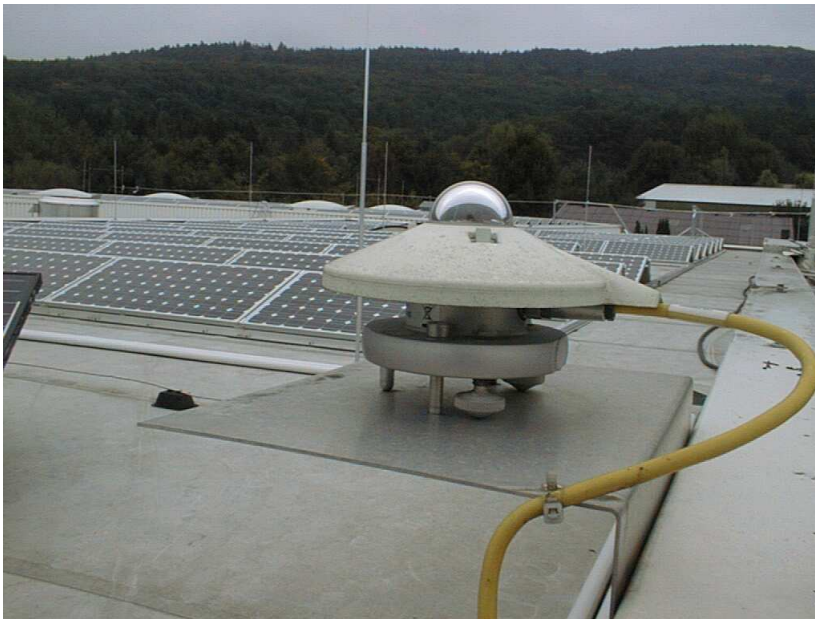
Img 1: Pyranometer CMP3, Kipp & Zonen
